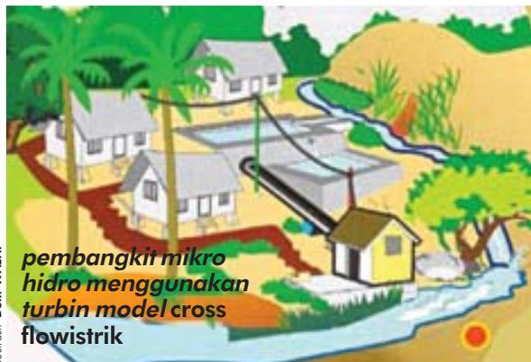
**pembangkit mikro hidro menggunakan turbin model cross flow listrik**
